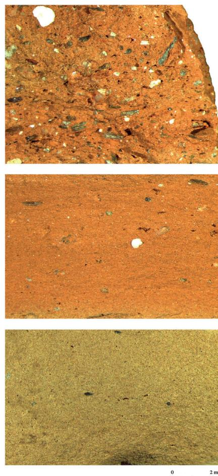
Fig. 2. Microfotografías de sección de fragmentos cerámicos de la categoría común (grupos A, B y C).
